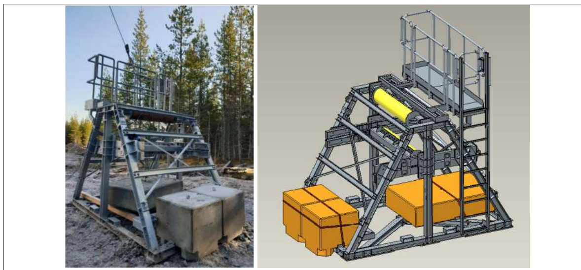
Abbildung 51 Darstellung eines Gestells für die Reibseilabspannung
